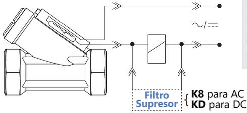
¡ No conectar nunca directamente a un motor, lámpara o cualquier carga superior de 20W ! Utiliza siempre un contactor o relé.
